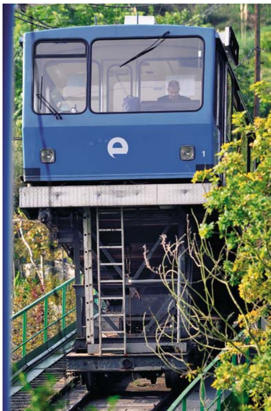
La Reineta funikularreko ibilgailuen xehetasuna. Hasierako bi bastidore daude oraindik, baina kaxak aldatu egin ziren 1986. urtean. (Santi Yaniz)
