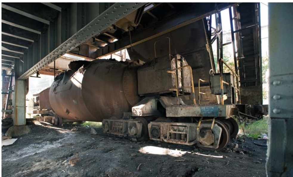
Arrabio garraioko torpedo bagoia. (Santi Yaniz) Vagón torpedo de transporte de arrabio. (Santi Yaniz)
