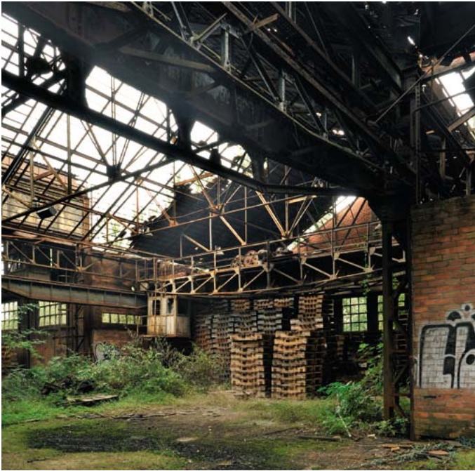
Zurezko kabinako antzinako zubi-garabiak. (Santi Yaniz) Antiguas grúas puente de cabina de madera. (Santi Yaniz)
