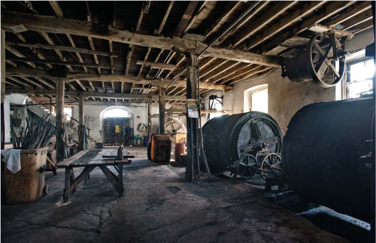
Behoko solairuan ontzen zen larrua. Uhal eta lokazte sistemak dituen makina bilduma dago oraindik ere. Larrua ontzeko lau bonboak nabarmentzen dira. (Santi Yaniz)
